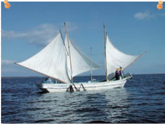
帆を張り風力でホッカイエビの生息場であるアマモ場で網を曳く様子 (写真提供:北海道水産業改良普及職員協議会「北海道の漁業図鑑」)
