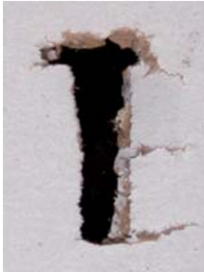
Ovan en trubbnosig 9 grams kopparprojektil kaliber 6,5 mm, som skjutits genom ett verklighetstroget provmedium och fångats upp 3 meter bakom detta. Expansionen är knappt dubbla projektildiametern och projektilens längd är obetydligt kortare än original. Vältningsbenägenheten är uppenbart stor.
