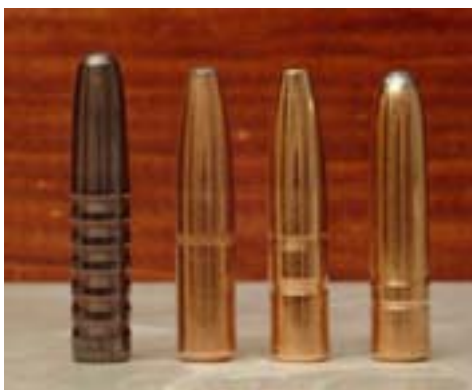
Till vänster en 6,5 mm kopparprojektil som väger 9 gram Den är betydligt längre än de tre 6,5 mm blyprojektilerna till höger som väger 10,1 gram. Rillorna i kopparprojektilen gör att den roterande massan i periferin blir mindre än om den vore helt slät. Sammantaget blir en sådan projektil mycket svårstabiliserad i nästan alla förekommande patronkombinationer och standardräffelstigningar
