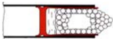
En hagelpipa med full choke har en strypning i mynningen på mellan 1-1,2 mm. Träffprocent på 35 m. c:a 75%
