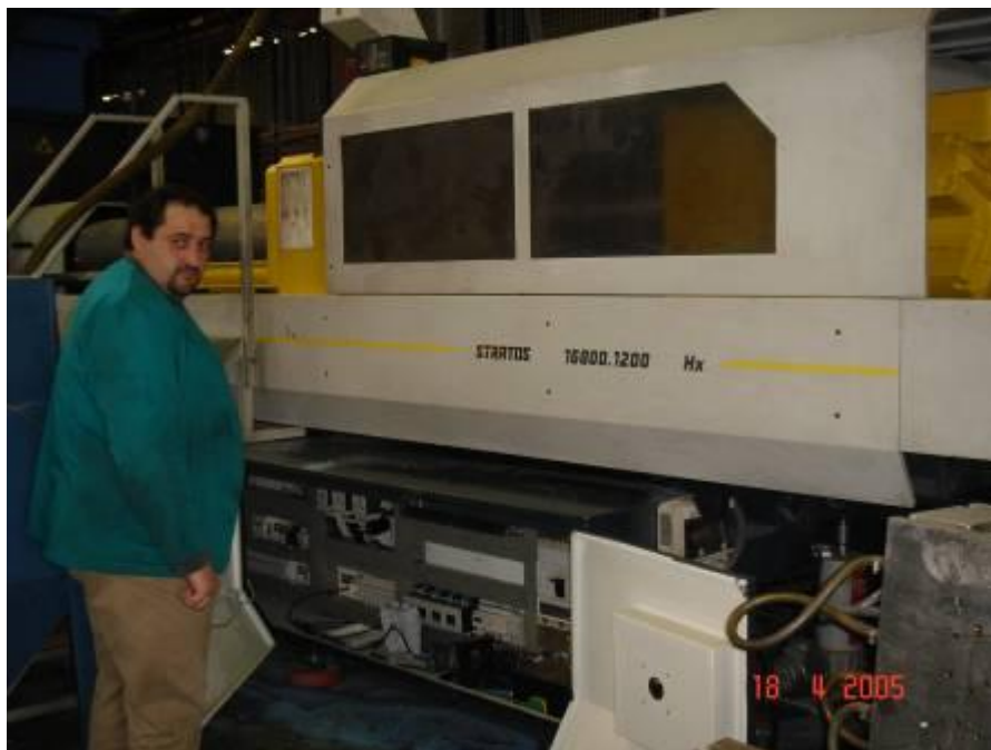
GCE montado sobre una máquina de inyección. Mantenimiento predictivo y control del gasto de transformación termoplástica (eficiencia eléctrica).
