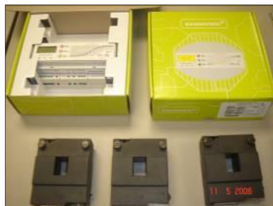
Ejemplo de Trafos no incluidos de 250 A (p. ej. para línea de producción) Relación de transformación → 250/5
