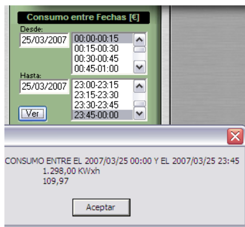
Cuantificación del Gasto Eléctrico producido durante un día festivo debido a iluminaciones superfluas
