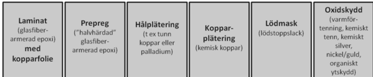
Figur 5.1. De delar av mönsterkortstillverkningen där kemiska föreningar blir kvar i det färdiga mönsterkortet.
