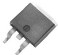
Figur 6.12a. MOSFET-transistor för ytmontering. MOSFET = Metal Oxide Semiconductor Fälteffekttransistor
