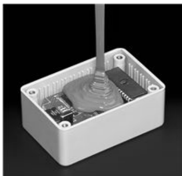
Figur 10.2a. Ingjutning av elektronik med en gjutmassa av silikon
