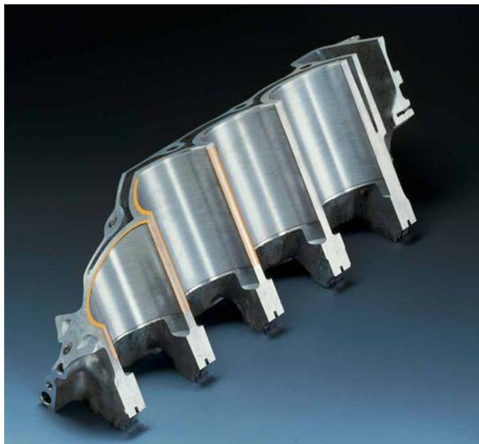
piazzato superiormente o inferiormente. Nel primo caso la struttura del blocco cilindri è closed deck, mentre nel secondo è open deck; il blocco, incorporato nel basamento, si riduce alle sole pareti esterne e ha pertanto una struttura estremamente semplice.
