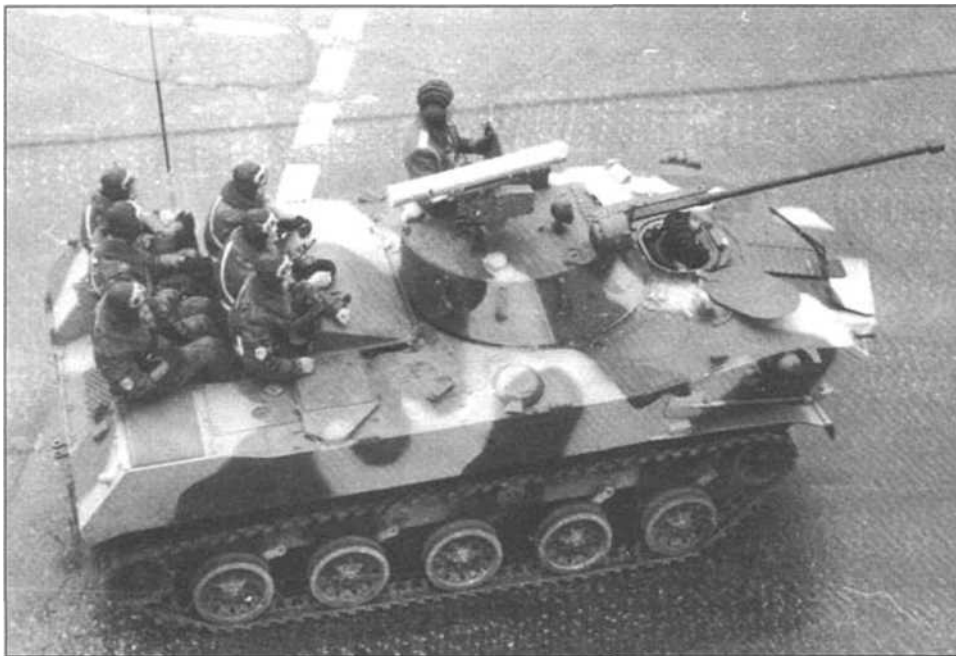
Вид сверху на БМД-2. Парадное размещение десантников такое же, как и на БМД-1. Москва, 7 ноября 1990 года
