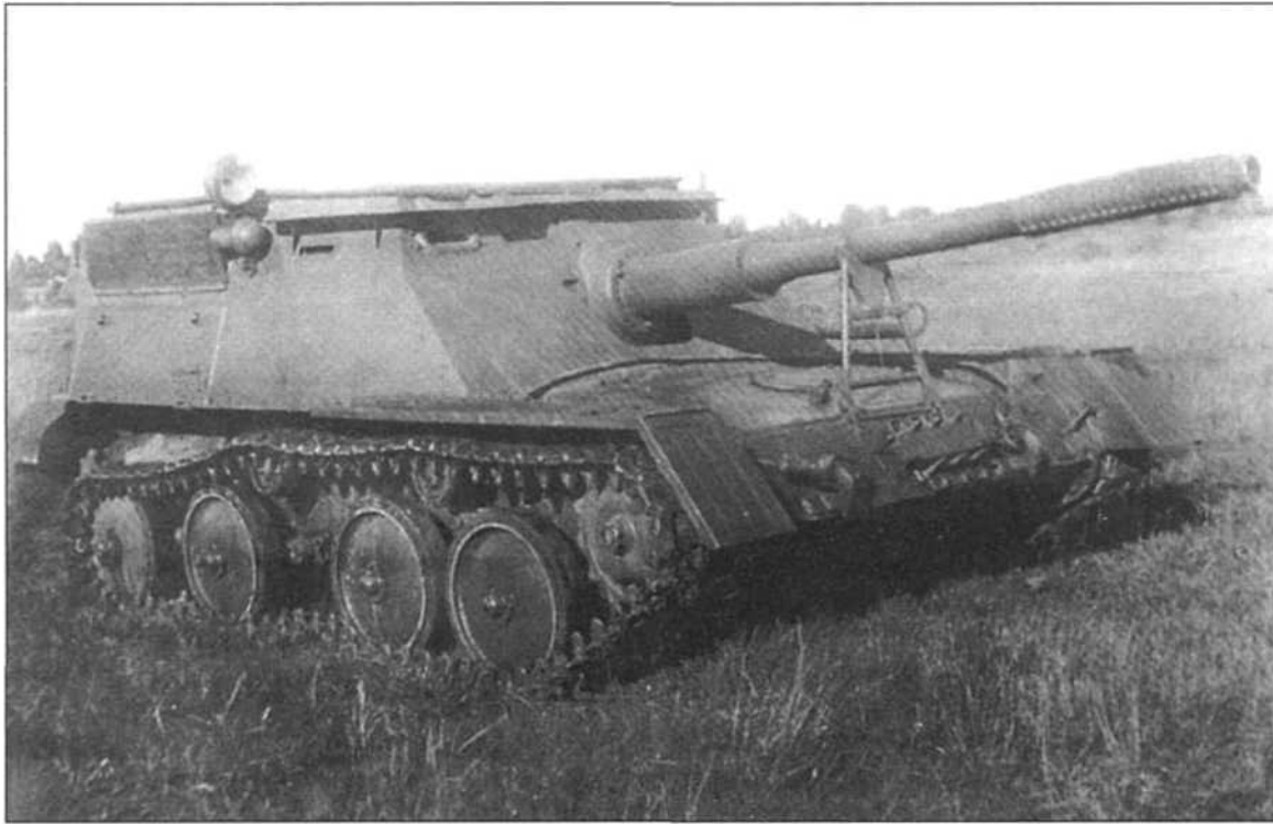
Первая отечественная авиадесантная самоходная установка АСУ-76. 1949 год
