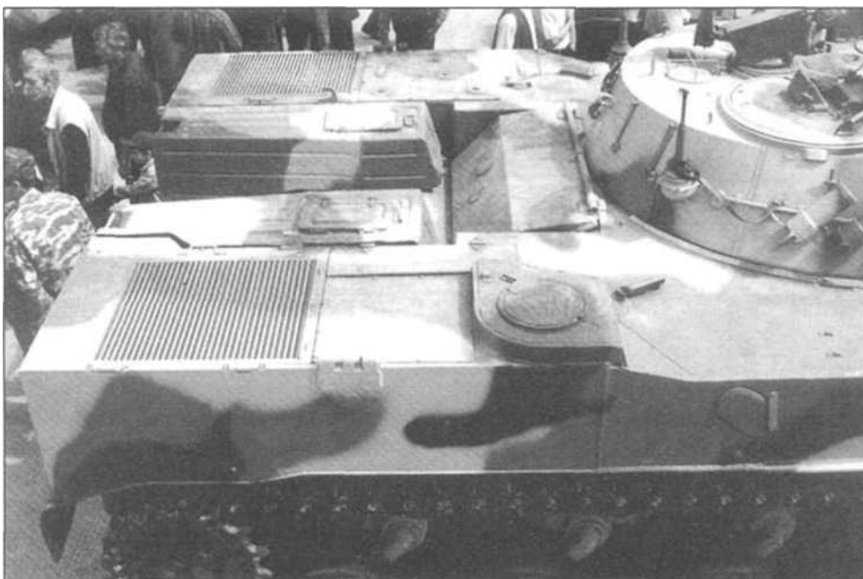
Кормовая часть БМД-3. Установленные на крыше МТО корпуса предназначены для перевозки инструментов и ЗИПа
