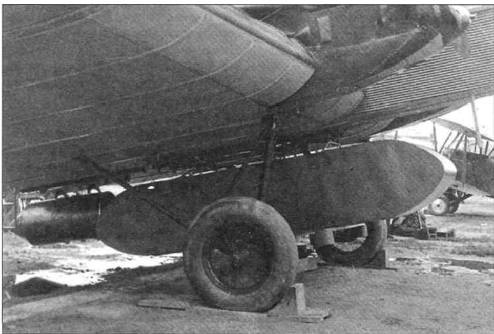
Грузовой ящик с парашютом под бомбардировщиком ТБ-1
