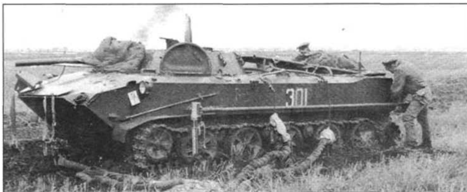
Подготовленная к десантированию БМД-1 с уложенными элементами парашютно-реактивной системы ПРСМ-915 (слева сверху). БМД-1 после приземления (слева внизу)
