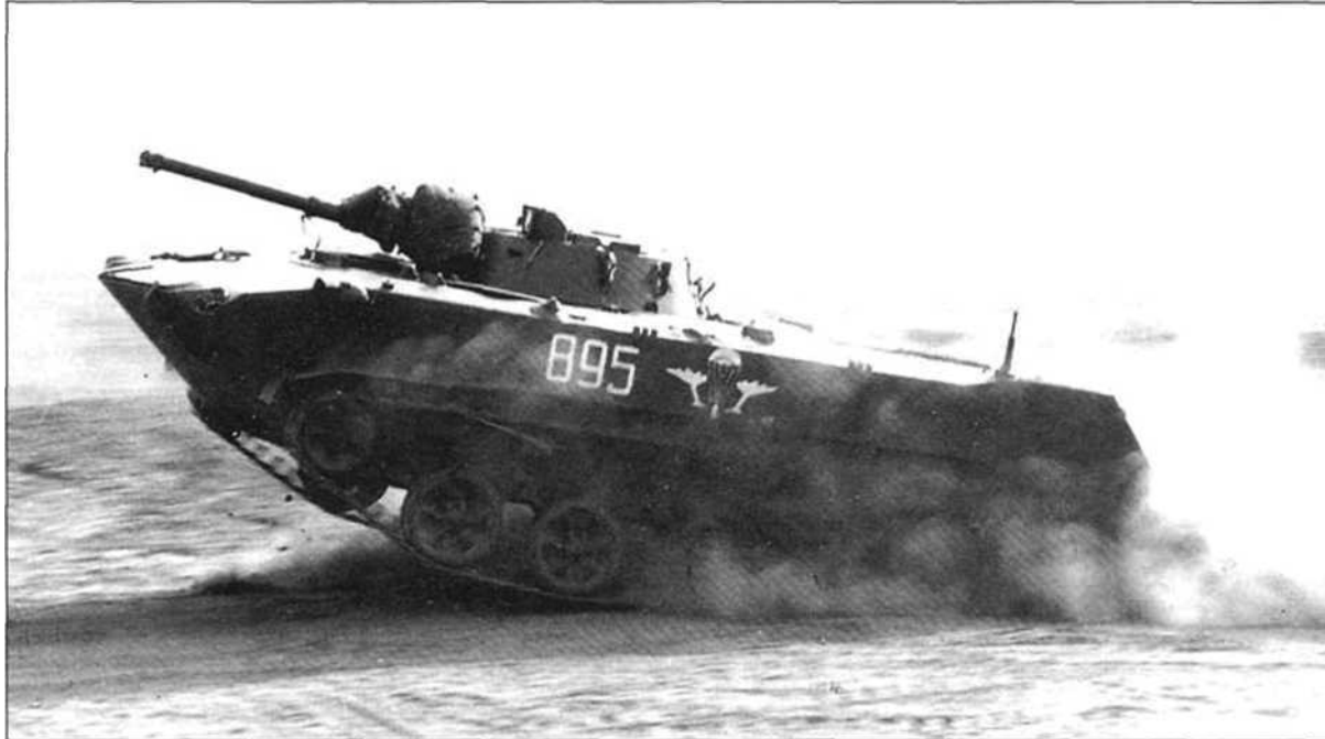
БМД-1 в атаке после приземления. На стволе орудия видны остатки укладки парашютно- реактивной системы ПРСМ-915. Учения «Запад-81», сентябрь 1981 года
