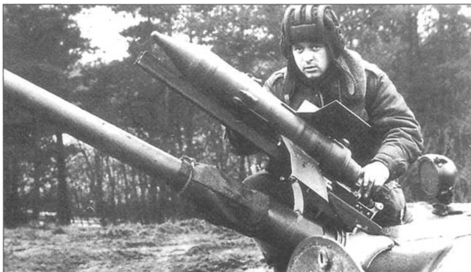
Пусковая установка с ракетой 9М14М «Малютка» на направляющей
