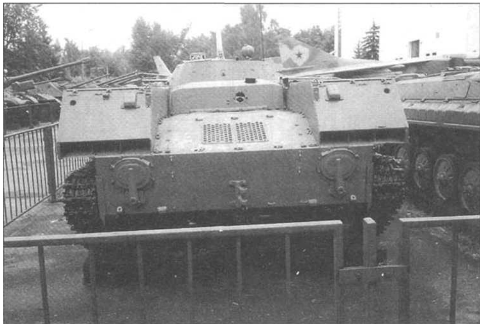
БМД-1, вид с кормы. Хорошо видны прибор наблюдения МК-4с и шаровая установка для стрельбы из автомата в крышке кормового люка
