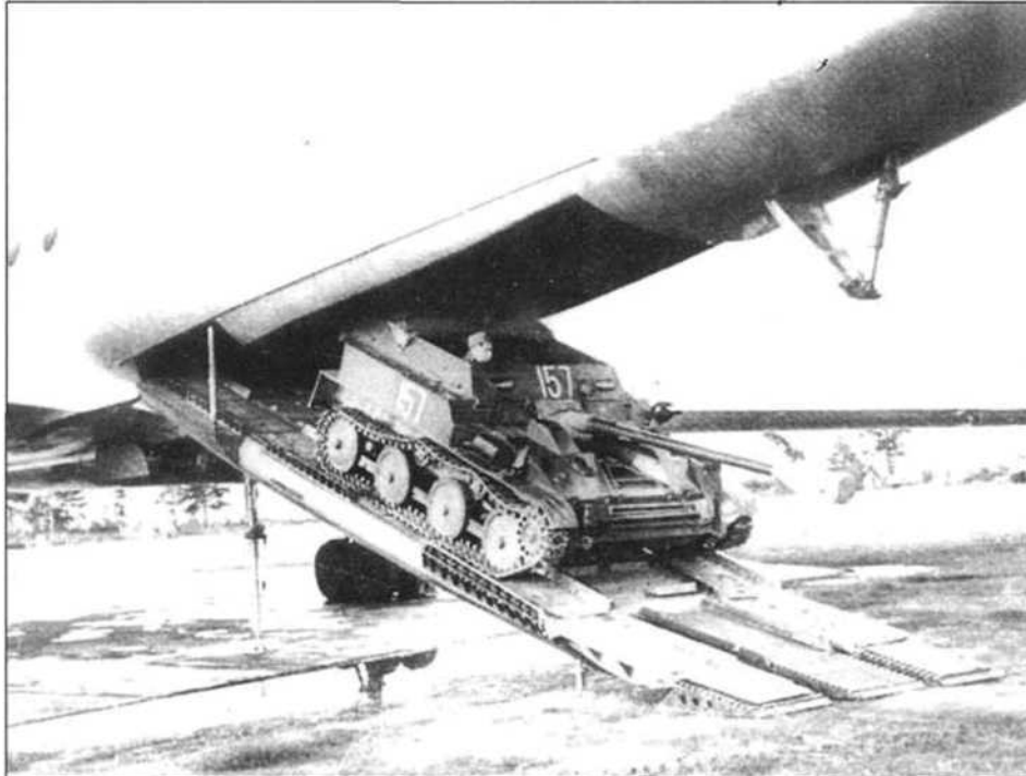
Выезд самоходной установки АСУ-57 из самолета Ту-107 (вариант Ту-104)
