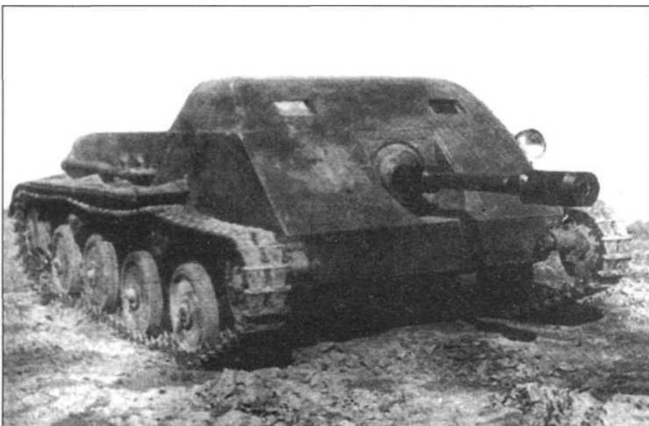
Опытный образец авиадесантной самоходной установки АСУ-57 завода № 115. 1948 год
