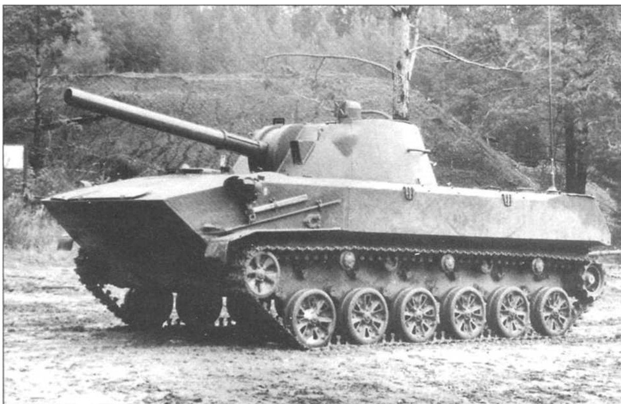
Самоходное артиллерийское орудие «Нона-С» в походном положении при максимальном клиренсе
