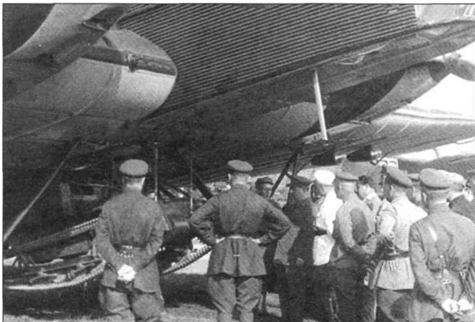
Танкетка Т-27 на подвеске ПД-Т под бомбардировщиком ТБ-1 (в центре). Осмотр танкетки Т-27 на подвеске ПД-Т. В белой гимнастерке — командарм М.Н.Тухачевский, левее него — нарком Г.К.Орджоникидзе, еще левее П.И.Гроховский, дающий пояснения. Москва, Центральный аэродром, июль 1934 года
