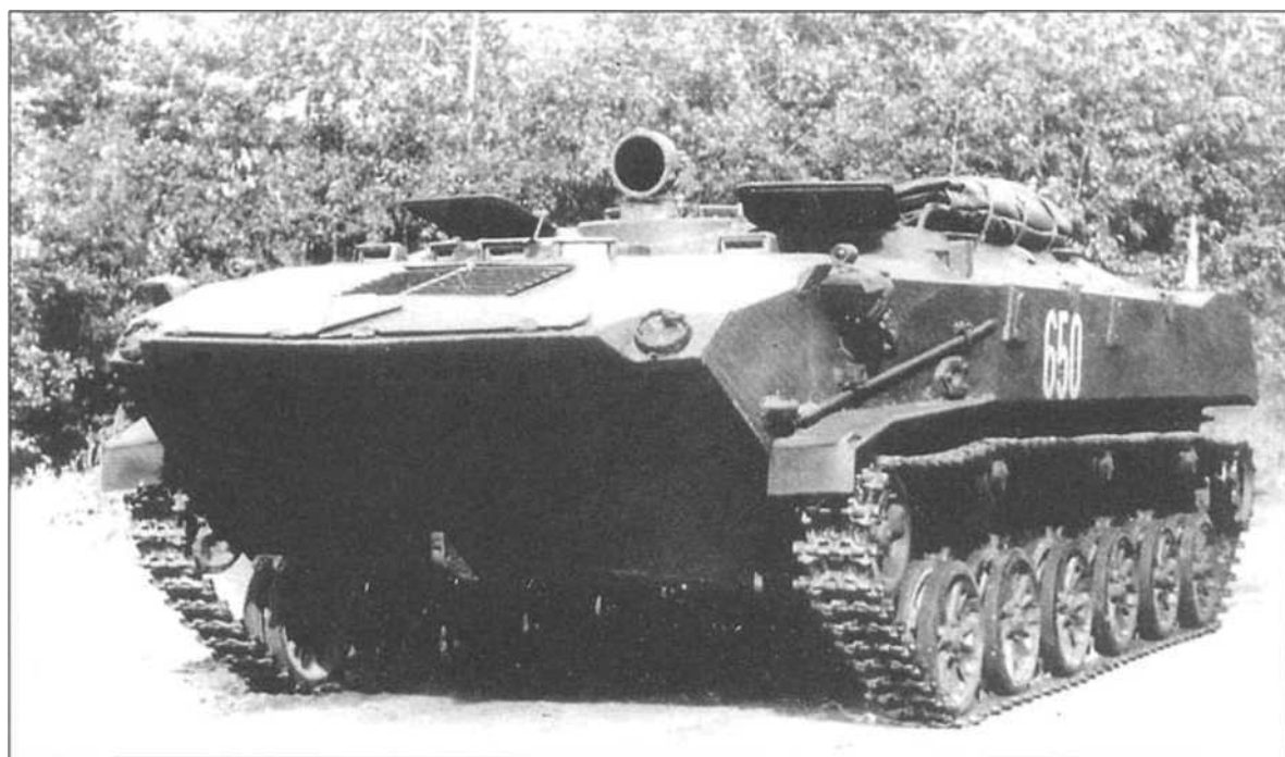
Серийный бронетранспортер БТР-Д. Люк командира десанта расположен в передней части крыши десантного отделения
