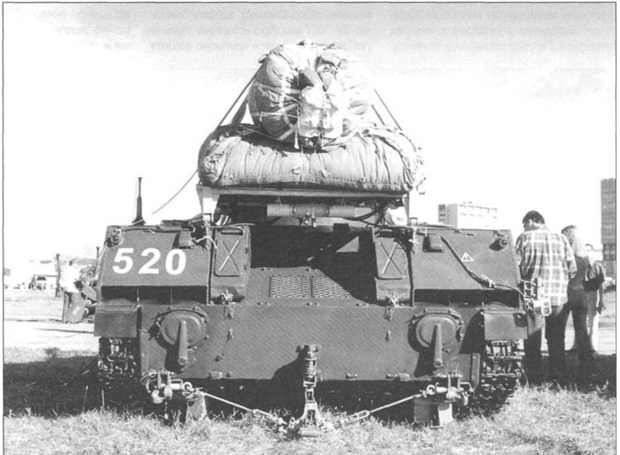
БМД-2 с уложенной парашютно-реактивной системой ПРСМ-916
