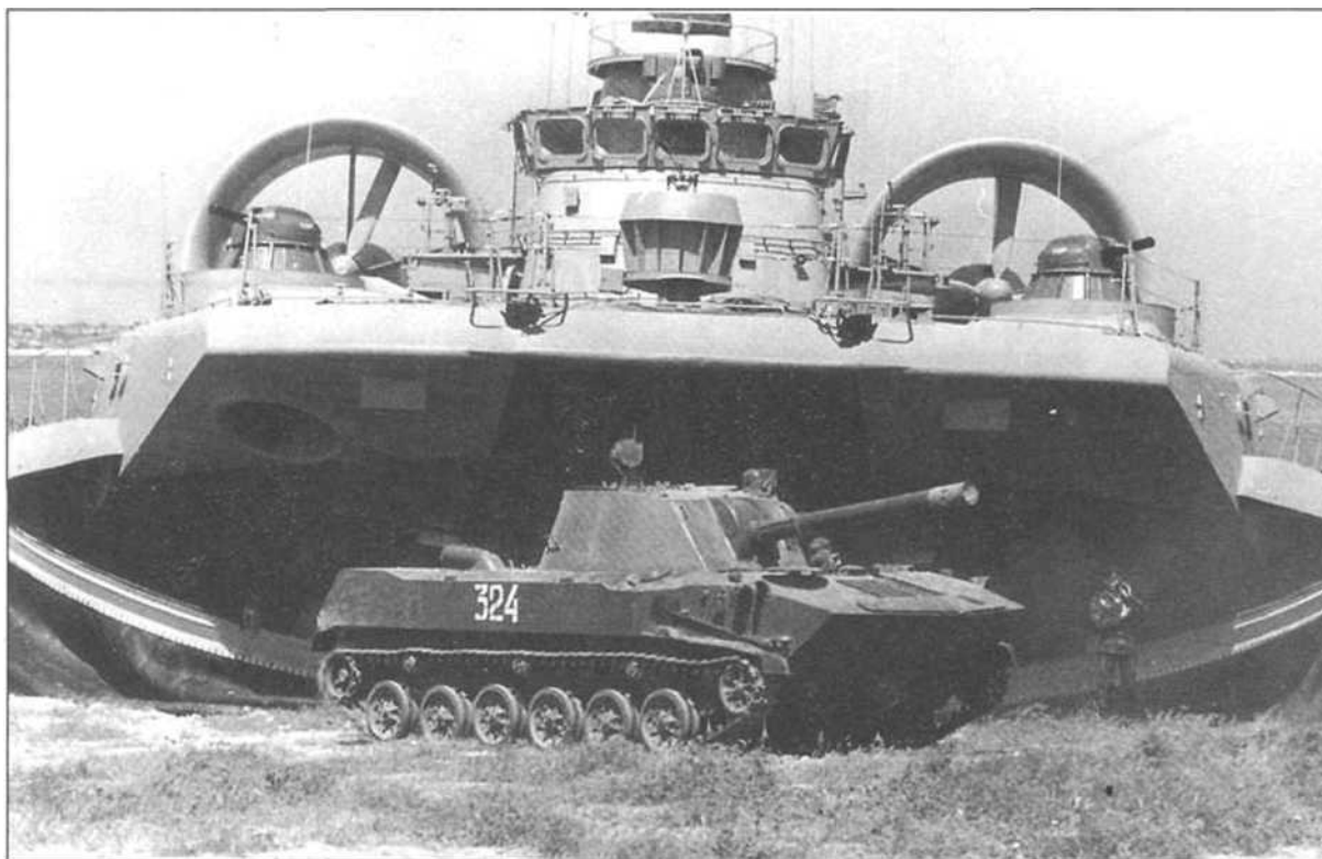
Самоходное орудие 2С9-1 «Свиристелка» одного из подразделений морской пехоты выезжает из десантного корабля на воздушной подушке
