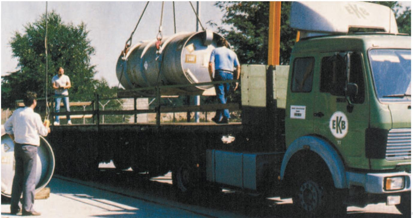
Abb. 8.9: Transport von Uranhexafluorid-Behältern
