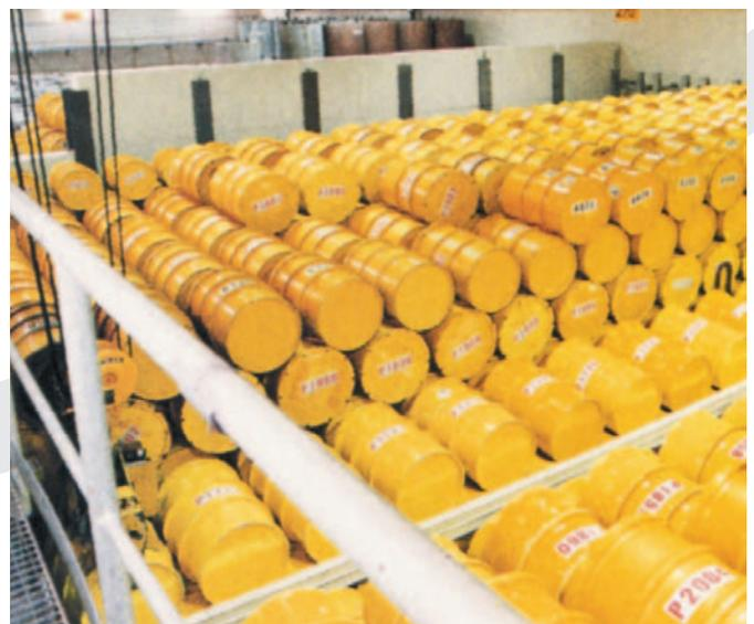
Abb. 8.13: Lagerung von in Stahlfässern verpacktem radioaktivem Abfall in einem Kernkraftwerk
