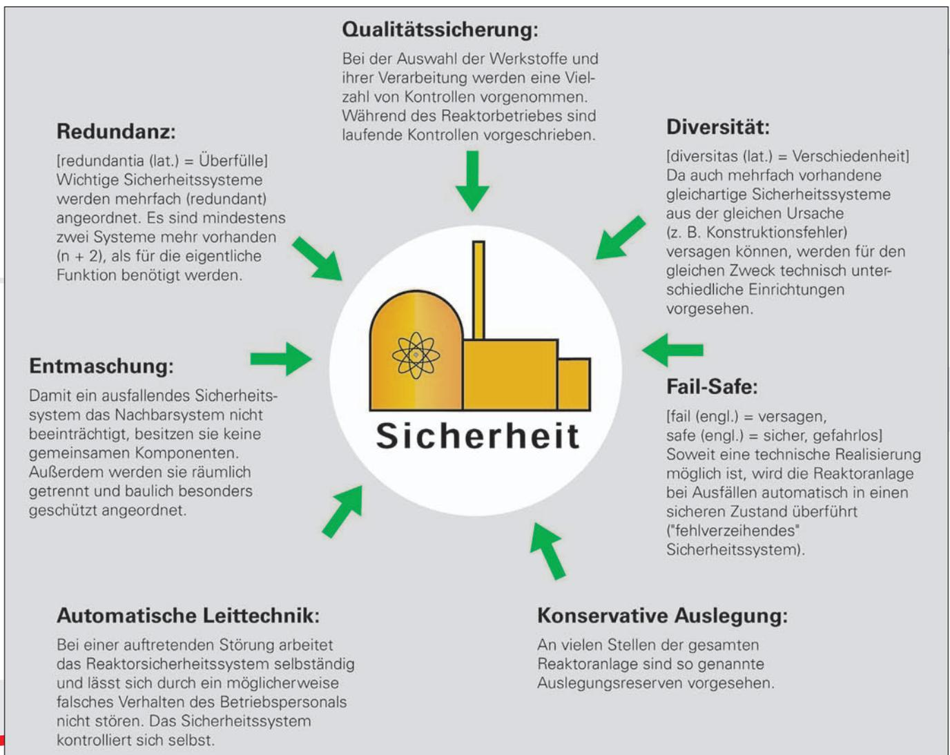
Abb. 7.4: Technische Grundsätze zur Erhöhung der Sicherheit eines Kernkraftwerks
