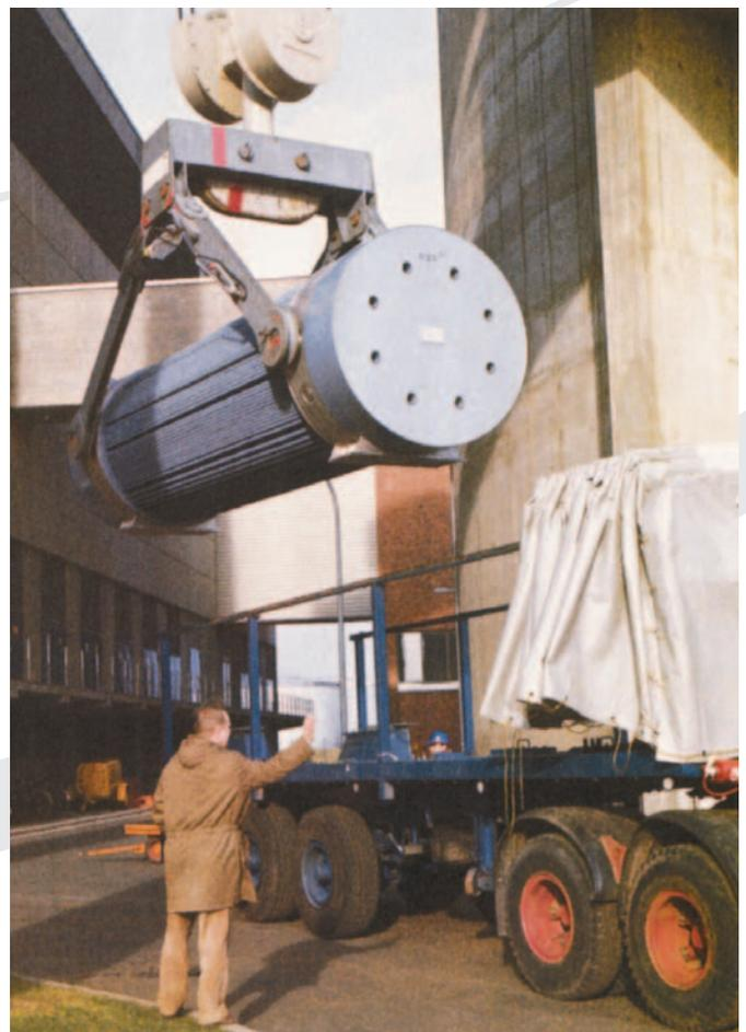
Abb. 8.10: Transportbehälter für abgebrannte Brennelemente
