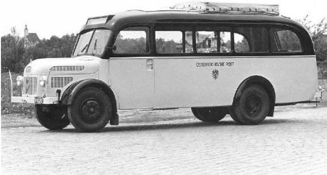
7) Steyr-Diesel-Omnibus Typ 380a, 90PS, 4 Zyl., Baujahr 1949
