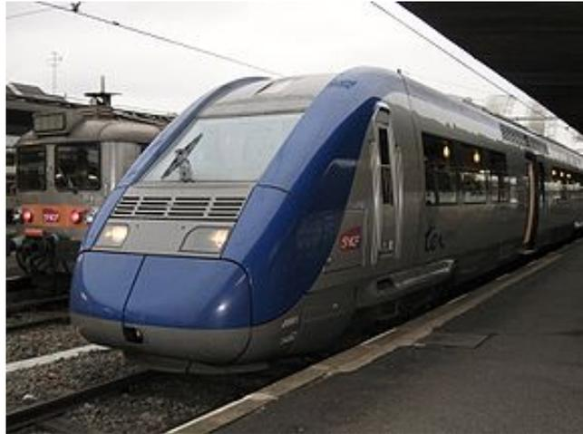
*Figure 17 : Une automotrice Z 21500, capable de rouler à 200 km/h, en gare d'Orléans*
