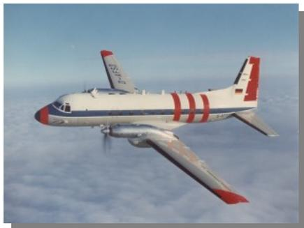
Die BFS erhielt die erste zur Flugvermessungsmaschine umgebaute HS 748 (D-ADSD, W.Nr. 1656) am 12. Februar 1969 auf dem Flughafen Frankfurt. Das Gewicht der Messeinrichtungen im Innern betrug 2,5t und bestand unter anderem aus Empfängern, Multimetern, Sensoren, Oszilloskopen, Computern, Frequenzanalysatoren, Fernsehkameras, Bildschirmen und diversen Auswerte- und Kommunikationseinrichtungen.
