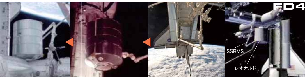
山崎宇宙飛行士は、ISSのロボットアーム(SSRMS)でシャトルの貨物室から多目的補給モジュール「レオナルド」を取り出しISSに取り付けた。地上からの物資の運び込みがいよいよスタート
