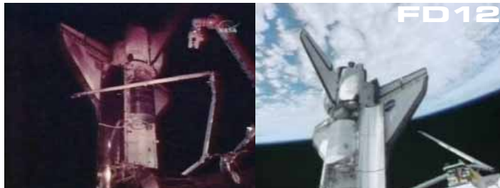
「レオナルド」をシャトルの貨物室に収納した後(写真右)、山崎宇宙飛行士はISSのロボットアームと、センサ付き検査用延長ブームを使ってシャトルの機体の後期点検を行った(写真左)
