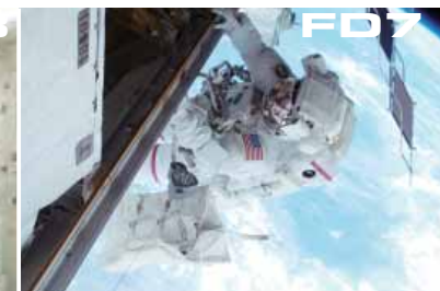
この日の船外活動で、古いATA(アンモニアタンク)が新しいATAと交換された。ATAは、ISSから発生する熱を冷却するためのアンモニアを収容しておくもの
