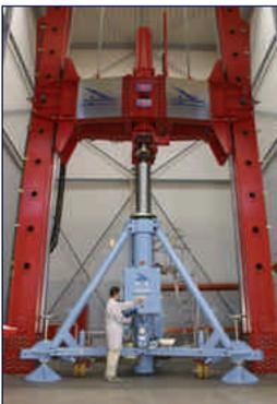
Dreibockheber unter dem HYDRO eigenen Prüfstand
