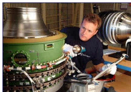
Der erste Hochdruckverdichter für das A400M-Triebwerk
