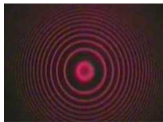
Abbildung 6: Interferenzmuster, wie es auf dem Spalt zu sehen war
