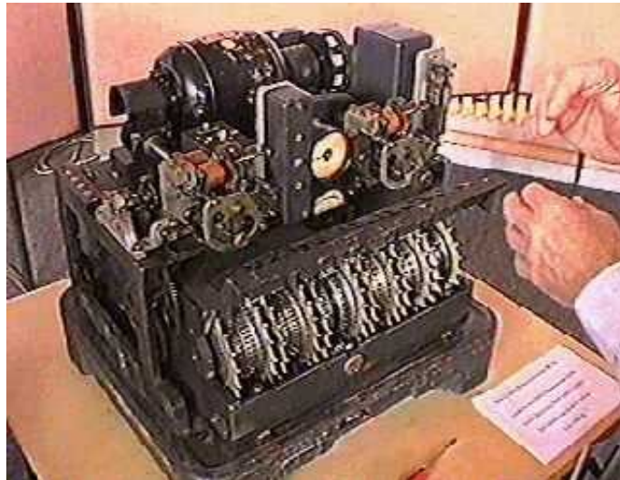
Bild 30: LORENZ SZ42 – Chiffrierzusatz zum LORENZ-Fernschreiber 206 (Schlüsselräder-Abdeckung offen)
