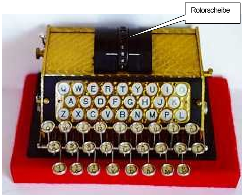
Bild 7: HEBERN'S Rotor-Chiffriemaschine (ca.1918) 58
