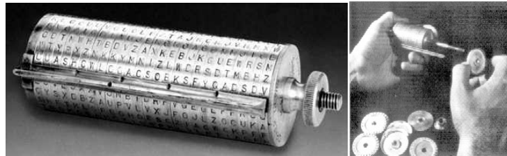
Bild 2: Chiffrierzylindergerät M-94 der US-Army 42
