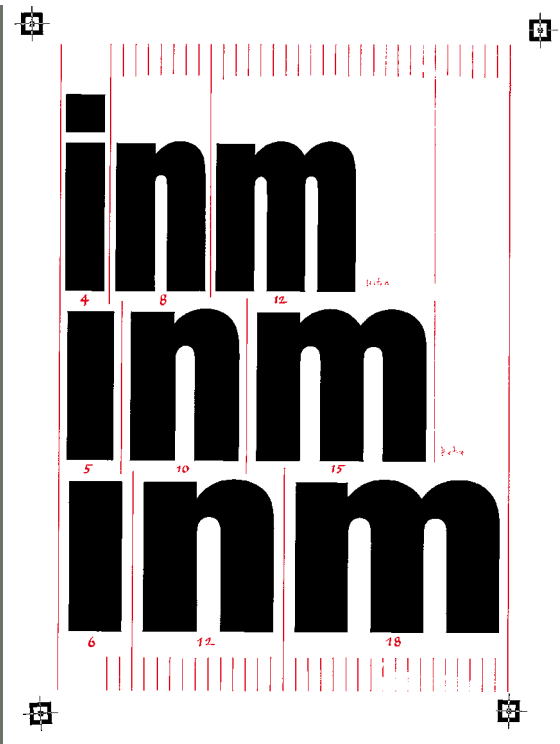
↑ Helvetica Compressed, 1966. The diagram on the right shows how the 18-unit spacing system of Mergenthaler's Linofilm phototypesetter determined the proportions of this three-part series. Helvetica Compressed, 1966. Nákres vpravo znázorňuje, jak osmnáctibodový proklad sazečního stroje Linofilm Mergenthaler předurčuje proporce této třídílné písmové sady.
