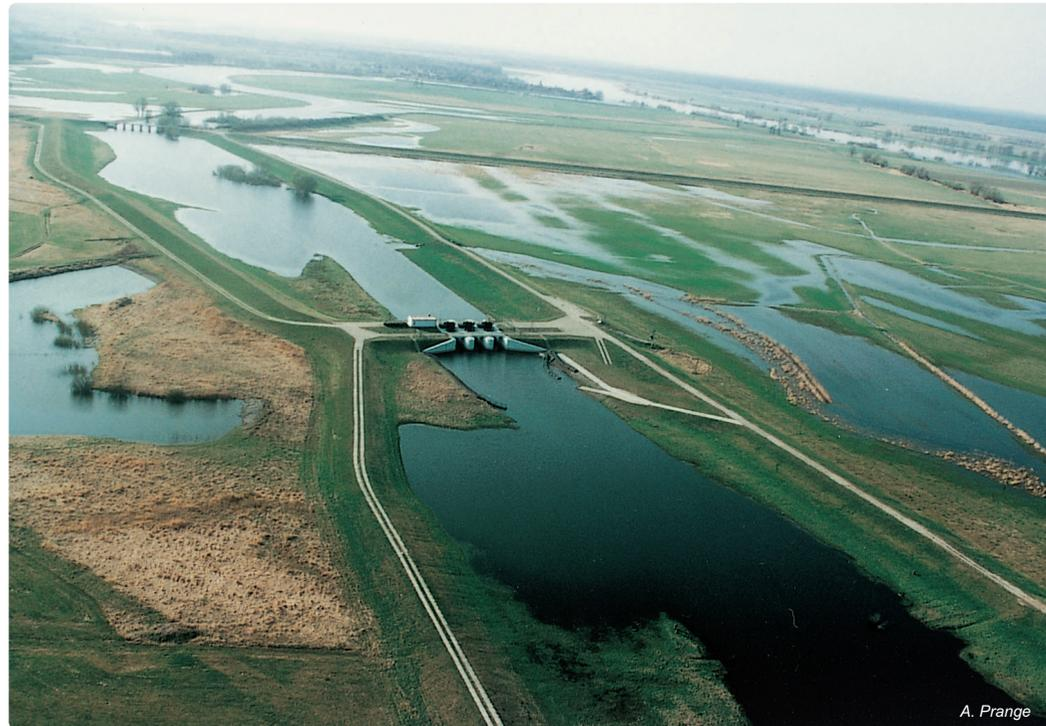
Abb. 4.10-7: Aland mit Absperrbauwerk vor der Mündung in die Elbe (oben rechts) und den Poldern Garbe (rechts) und Wrechow (links)
