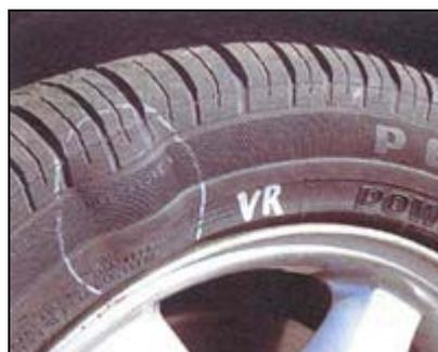
**Abbildung 39:** Ausbeulung der Reifenflanke durch verletzte Gitterstruktur
