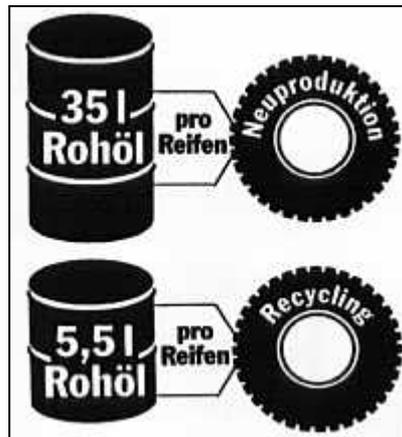
**Abbildung 33:** Vergleich des Rohölverbrauchs bei Neu- und runderneuertem Reifen [2]
