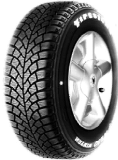
**Abbildung 17:** Winterreifen mit Lamellenprofil
