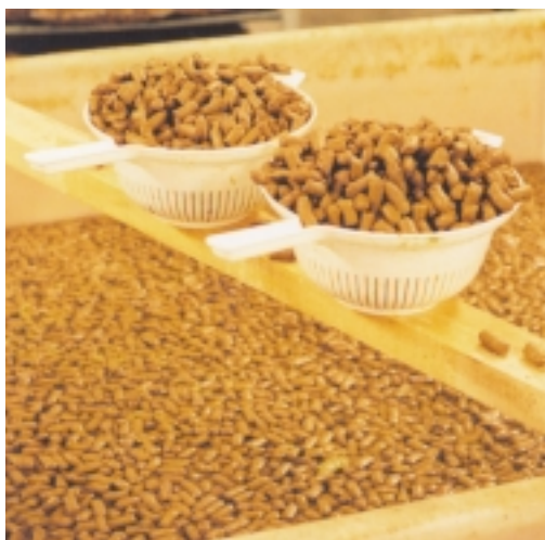
Ferdig pellet, etter at råstoffet er tilsatt Algibind og kjørt gjennom gelingsprosessen. En herdingsprosess gjør pelleten fast, ikke-klebende og uoppløselig i vann. (Foto: Gellyfeed)
