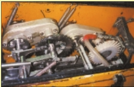
Sløyemaskin i trålerflåten: Buken skjæres opp, og innholdet i bukhulen børstes ut. Innmaten blandes med store mengder vann – og blir dårlig egnet for sortering og videre behandling.
