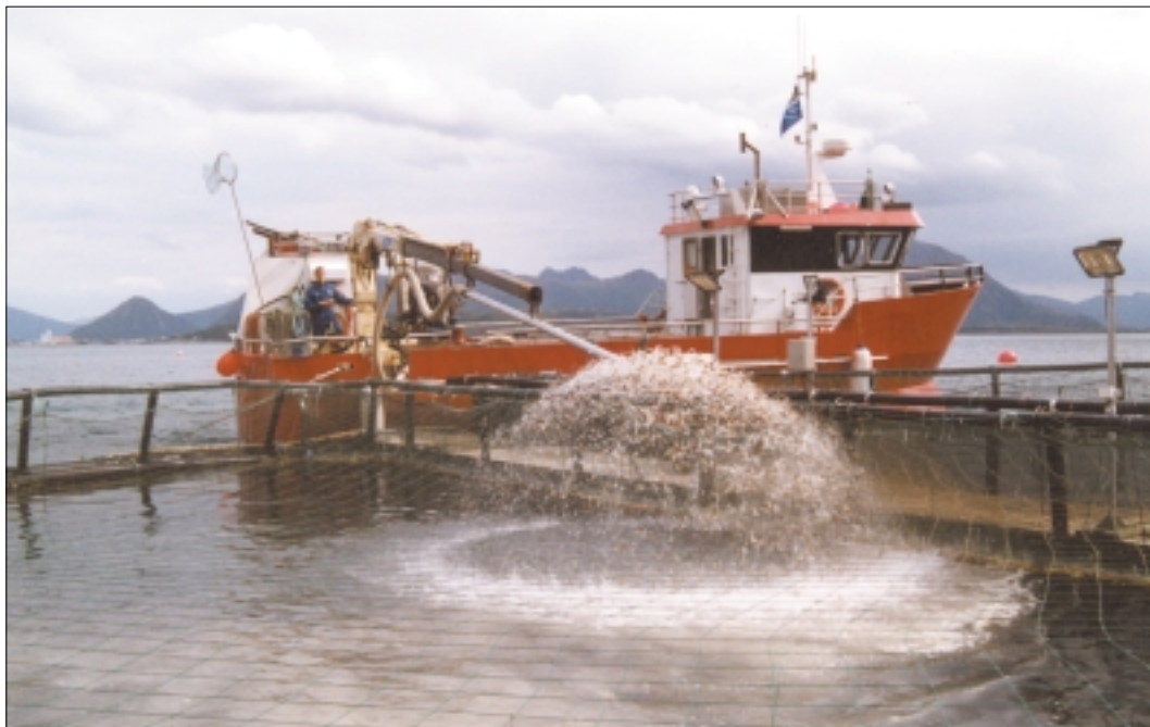
Fôring med RUBIN-fôr ved Øyfisk AS. Det er utviklet et vakuumpumpesystem installert på fôringsbåt. (Foto: RUBIN)
