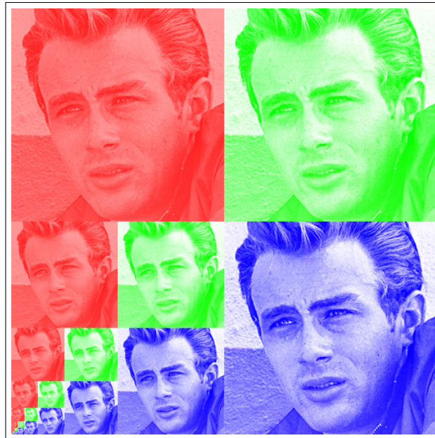
Abbildung 6.12. Ablage einer Textur im Texturspeicher, nach Farbkanälen separiert. In natürlicher Weise ergibt sich die halbierte Kantenlänge für die nächstkleinere Textur.
