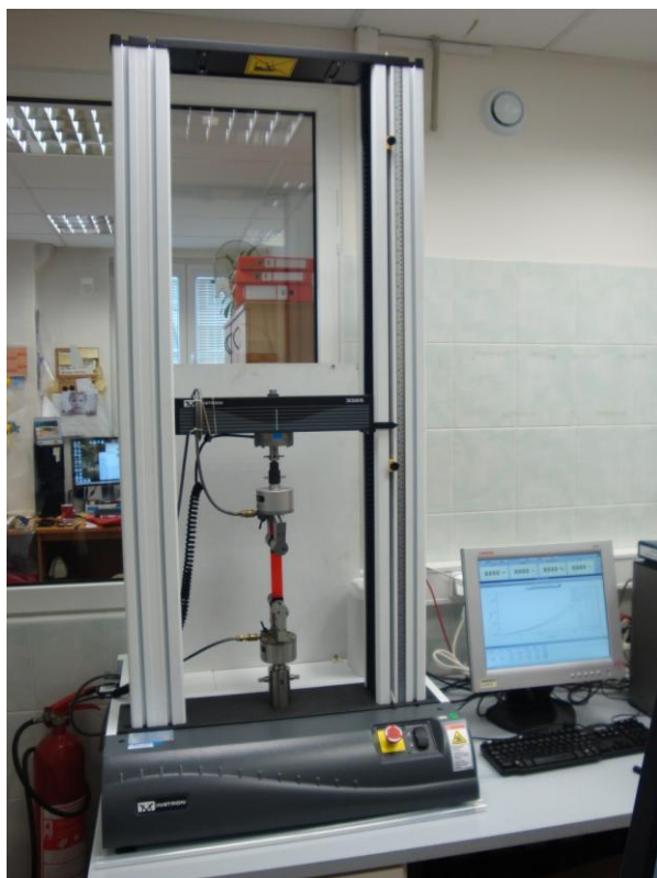
Obrázek 6: Zkušební přístroj Instron 3365 na měření pevnosti v tahu
