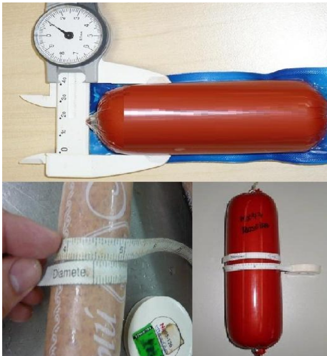
Obrázek 15: Aplikační zkoušky – měření kalibru po naražení
