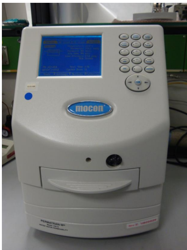
Obrázek 5: Zkušební přístroj Mocon Permatran W 1/50 G na měření propustnosti vodní páry
