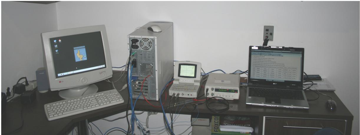
Figura 18: Bancada de testes onde os experimentos foram realizados. Da esquerda para a direita: computador em testes, osciloscópio, gerador de sinais e estação de trabalho
