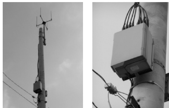
図5.20 NTTパーソナルPHS基地局 (左：全景、右：送受信装置)
