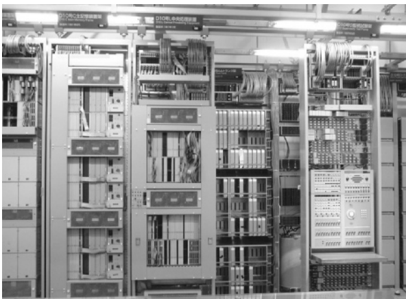
図4.15 自動車電話用D10自動電子交換装置 (NTT所蔵)
