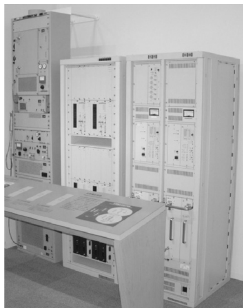
図4.7 無線呼出基地局装置 (左からTC11：150MHz送信装置，CE15：符号化装置，TC15：280MHz送信装置) (NTT所蔵)
