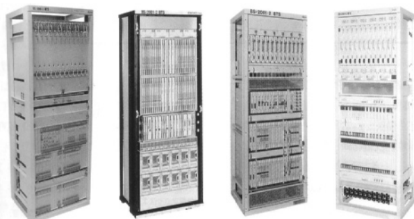
図6.10 WCDMA無線基地局装置機の概観 9)
