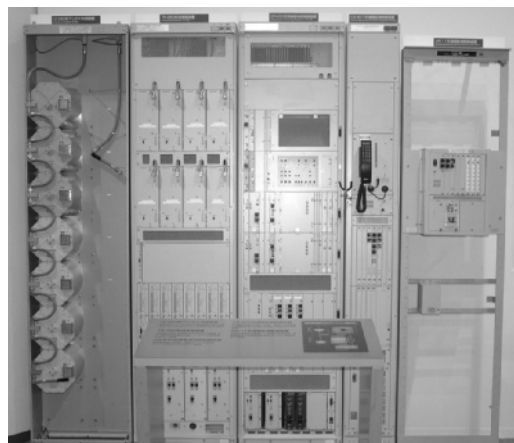
図4.4 新内航船舶電話の基地局（NTT所蔵）
