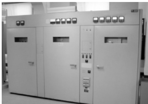
図3.10 SSB短波送信機（4.7～20MHz、10kW、KDDI所蔵）
