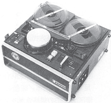
【写真 15】 NV-3020 型統一 I 型 VTR (松下 / 1969 年)
