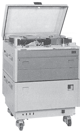
【写真14】デジタルTBCと組合わせた TT500型VTR（NEC／1974年）
