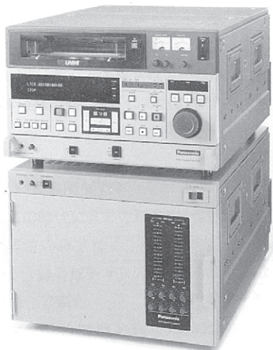
【写真30】AU-HD1055型 可搬形ハイビジョンVTR(松下/1989年)
