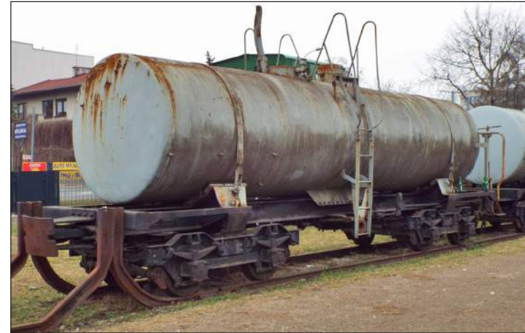
Ryc. 1. Wagon cysterna typu 3Rw do przewozu paliwa lotniczego zbudowany w zakładach „Zastal” w Zielonej Górze na zamówienie Ministerstwa Obrony Narodowej. Wagony te używano na kolejach grójeckiej i koszalińskiej (fot. Autor, Chabówka, lato 2007 r.).
