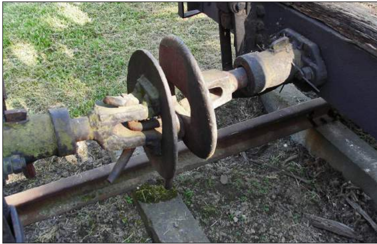
Ryc. 7. Oryginalne poniemieckie sprzęgi w wagonach używanych dawniej na Wojskowej Kolei Wąskotorowej w Zielonce, a obecnie znajdujących się w zbiorach Muzeum Kolei Wąskotorowej w Sochaczewie (fot. Autor, lato 2008 r.).
