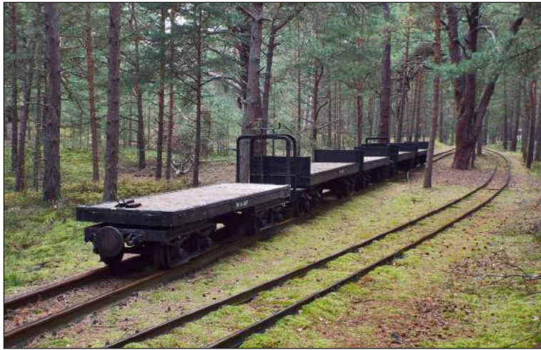
Ryc. 36. Typowe dla kolei wąskotorowej na Helu wagony platformy służące do przewozu uzbrojenia (fot. Autor, lato 2015 r.).
