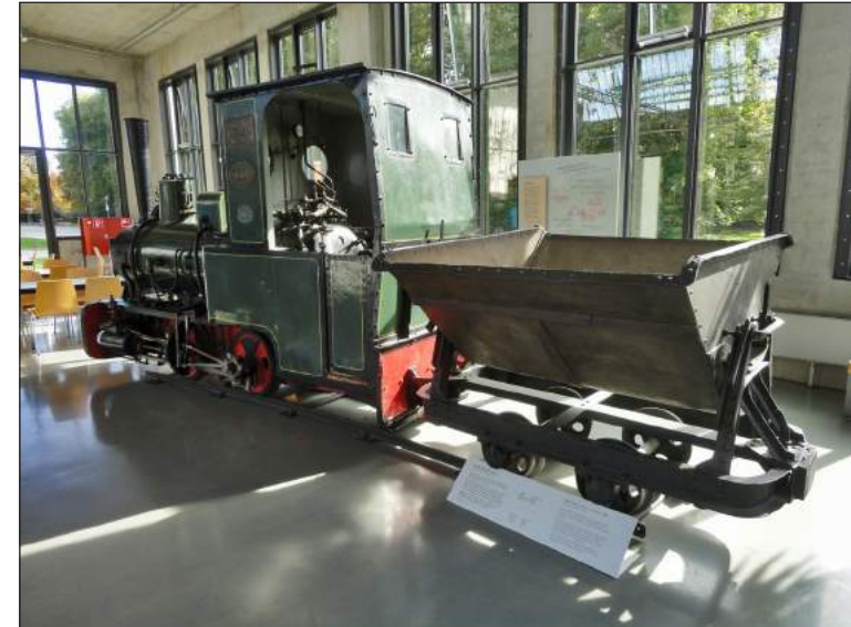
Ryc. 1. Parowóz firmy Krauss & Wagners z Kassel w Niemczech jest przykładem taboru kolei polowej używanej w budownictwie oraz przemyśle rolnym i wydobywczym; posiada tylko niewielkie zasobniki na wodę i węgiel, co ograniczało jego zasięg do terenu zakładu (np. cukrowni, gorzeln, kamieniołomu); zastosowanie jego skokowo zwiększyło zdolności przewozowe w porównaniu z używaną wcześniej trakcją konną; lokomotywa wraz z wagonem (kolebą) poruszała się po montowanym z gotowych elementów torowisku, którego fragment znajduje się na zdjęciu; egzemplarz z Deutsches Museum Verkehrszentrum Am Bavariapark w Monachium (fot. Autor, 2019).
