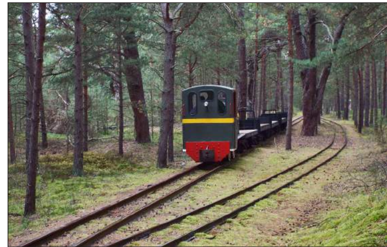
Ryc. 34. Skład wojskowych platform na leśnej mijance prowadzony przez lokomotywę WLS40 – WP 11-40372 (fot. Autor, lato 2015 r.).
