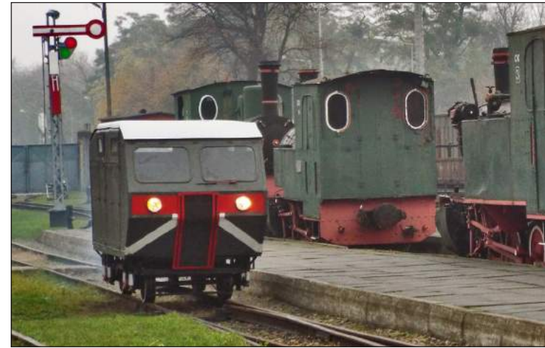
Ryc. 9. Zbudowana sposobem gospodarczym drezyna motorowa DSNA175/68 używana na Wojskowej Kolei Wąskotorowej w Zielonce, stanowiąca obecnie czynny eksponat w Muzeum Kolei Wąskotorowej w Sochaczewie (fot. Autor, jesień 2017 r.).
