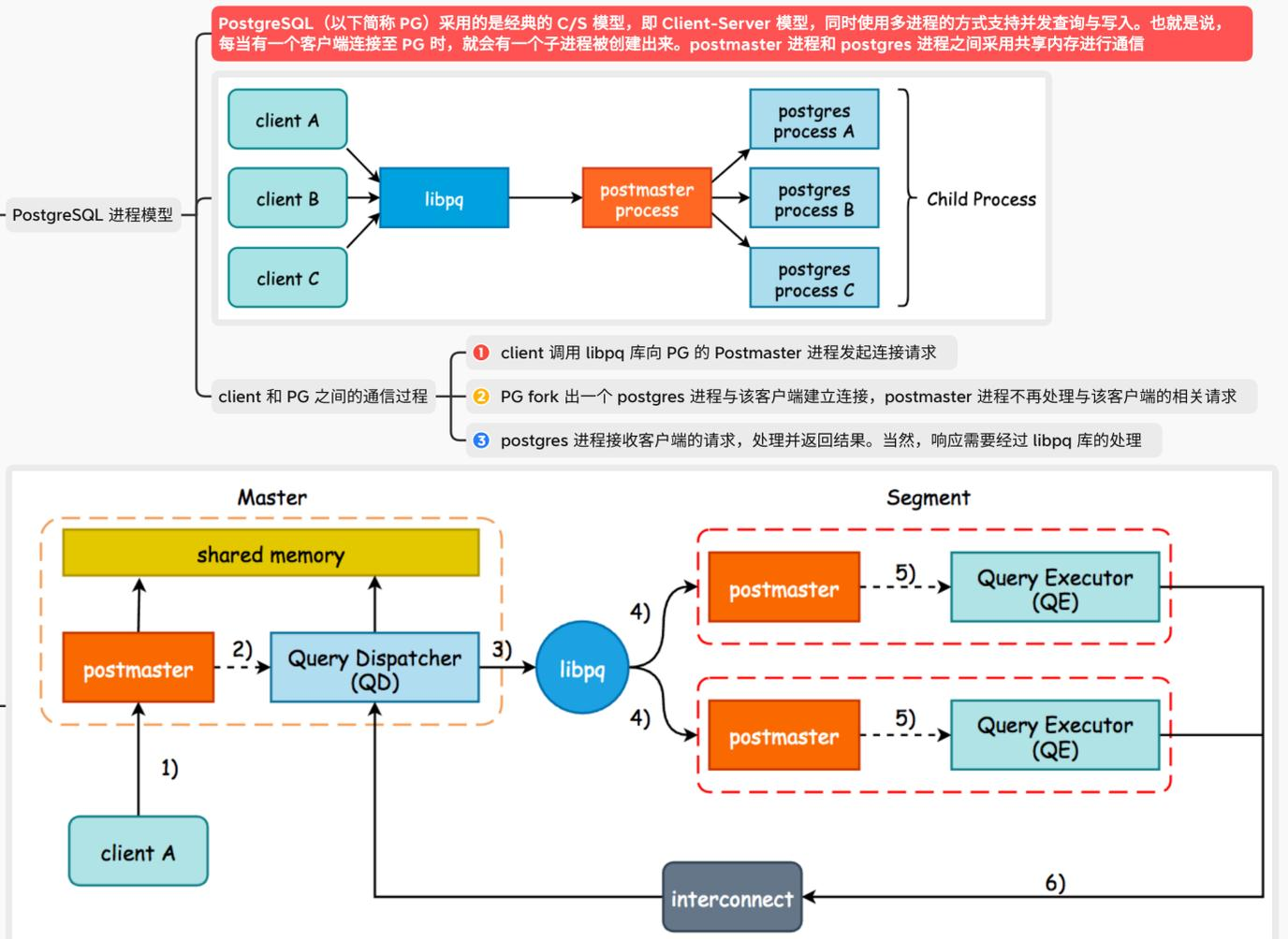
PostgreSQL（以下简称 PG）采用的是经典的 C/S 模型，即 Client-Server 模型，同时使用多进程的方式支持并发查询与写入。也就是说，每当有一个客户端连接至 PG 时，就会有一个子进程被创建出来。postmaster 进程和 postgres 进程之间采用共享内存进行通信
