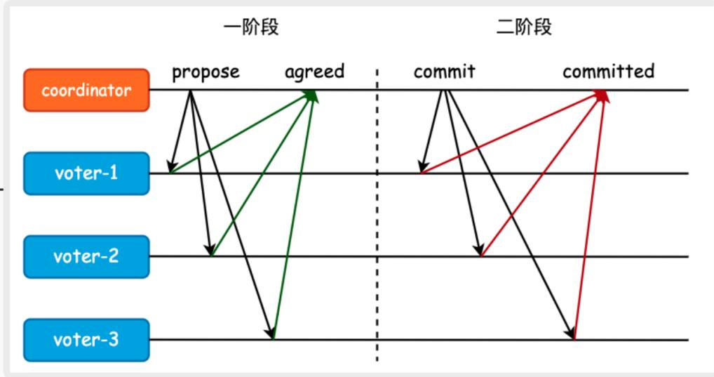
上图是一个通用的 2PC 模型, 将图中的 voter 替换成集群中对应的节点即可。在 Paxos、Raft 等共识算法中, 一阶段和二阶段只需要得到超过半数节点的成功即可。而在分布式事务中, 则必须得到全部节点的同意, 否则就会出现数据的不一致
