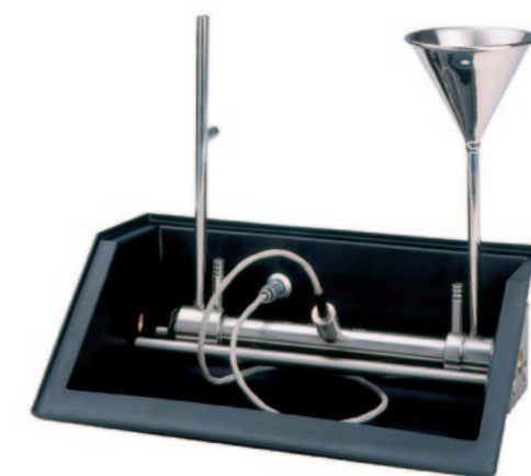
Durchflussmessröhre mit Temperaturensensor
