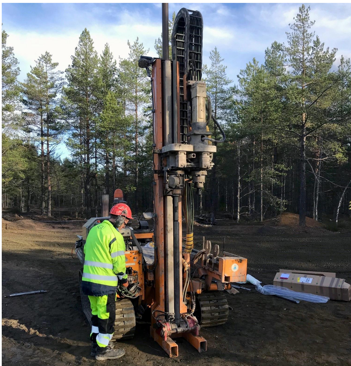
Figur 5. Borrning och djupprovtagning av anrikningssand vid Bäckegruvan, Riddarhyttfältet. Foto: Patrick Casey/SGU.
