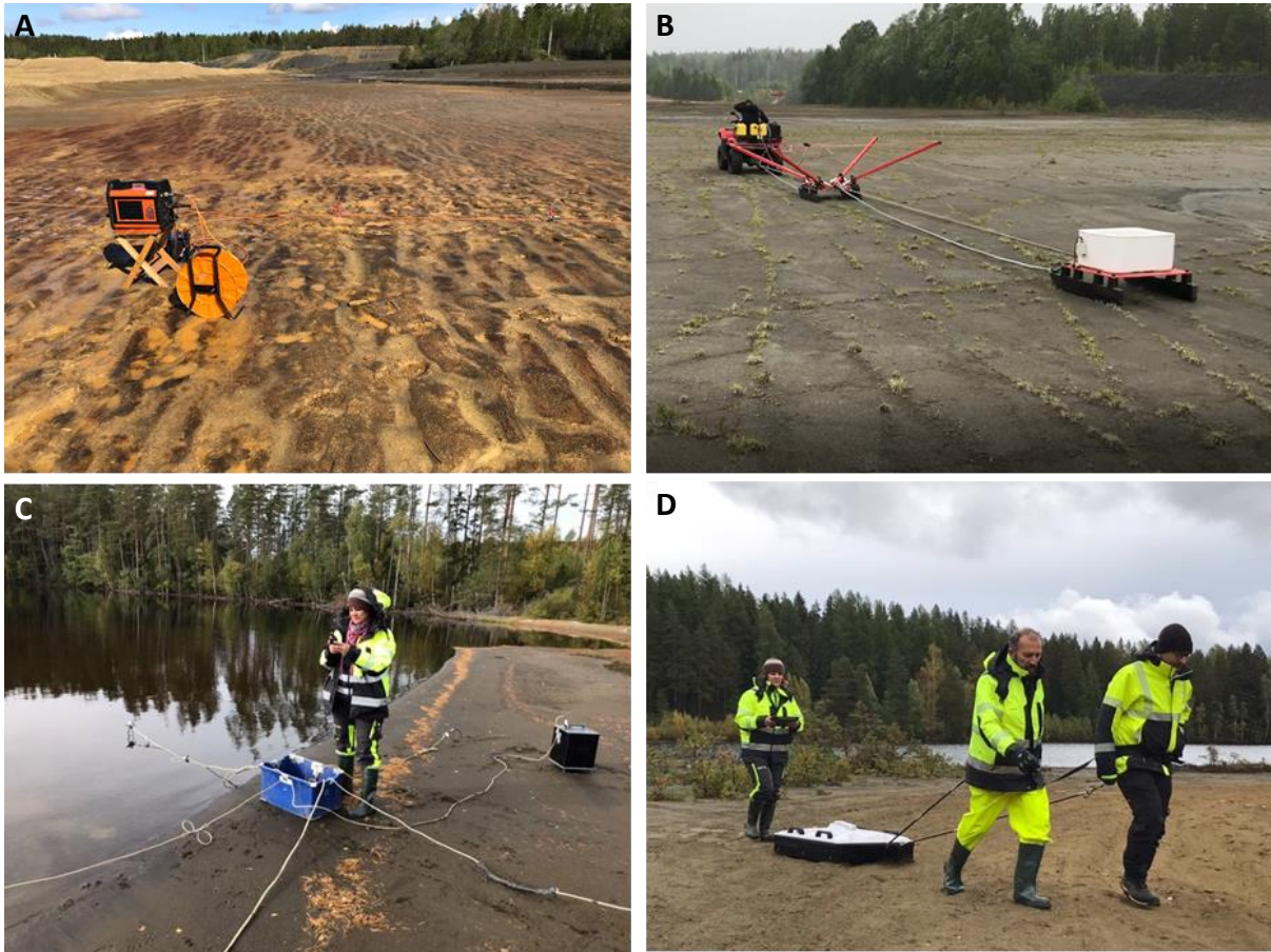
Figur 3. Foton som visar mätning med olika geofysiska metoder vid Bäckegruvans och Källfallets sandmagasin, Riddarhyttan. A. Elektrisk resistivitetstomografi (ERT), B. transient elektromagnetisk mätning (TEM), C. radiomagnetotellurik (RMT) och D. Georadar. Foto: Virginie Leroux /SGU (A) och Mehrdad Bastani/SGU (B–D).
