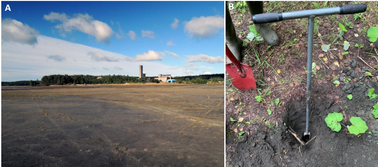
Figur 2. A. Bäckegruvans sandmagasin, sanden är mörkfärgad och magnetisk till följd av högt innehåll av järnoxidmineralet magnetit. Foto: Gunnar Rauséus/SGU. B. Provtagning av anrikningssand med spade och edelman auger , sandmagasinet vid Långnäs. Foto: Helge Reginiussen/SGU.
