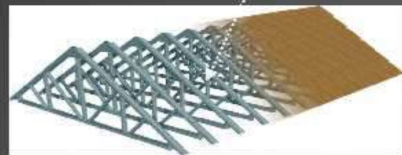
atap plana menggunakan struktur baja ringan
