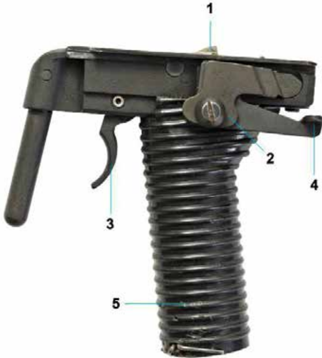
KUVA 36. Viritys- ja laukaisukoneisto. (1 Virekynnys, 2 Viritysvipu, 3 Liipaisin, 4 Varmistin, 5 Kädensija).
