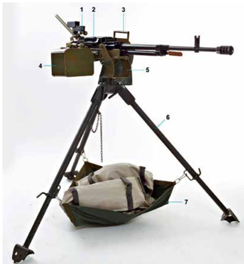
1 Heijastintähtäin, 2 Ilmatorjuntakonekivääri, 3 Vyölenkkipussi, 4 Vyölaatikko, 5 Jous-tokehto, 6 Tukikohtajalusta, 7 Painopurje.
