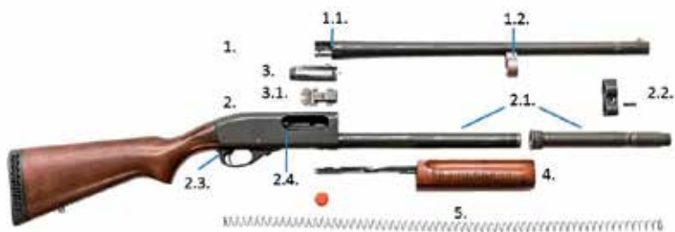
KUVA 217. 12 pumppuhaulikko Remington Police purettuna.
