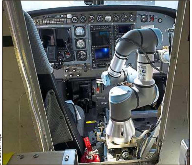
Un robot créé pour remplacer le copilote humain dans le cockpit.
