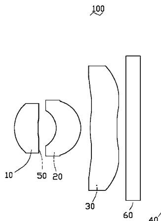
**【权利要求1】** 一种镜头系统，其从物侧到像侧方向依次包括一个正光焦度的第一透镜、一个正光焦度的第二透镜及一个负光焦度的第三透镜，其特征在于，该镜头系统满足条件式 (1)  $0.25 < R1F/F < 0.5$ ; (2)  $R2F < R2R < 0$  和 (3)  $0 < R1F < R1R$ ，其中  $R1F$ : 第一透镜靠近物侧的表面的曲率半径； $R1R$ : 第一透镜靠近像侧的表面的曲率半径； $R2R$ : 第二透镜靠近像侧的表面的曲率半径； $R2F$ : 第二透镜靠近物侧的表面的曲率半径； $F$ : 镜头系统的有效焦距。
