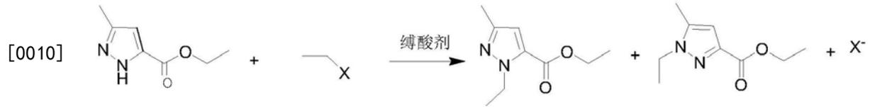
[0011] 将吡唑酯在溶剂条件下,加入缚酸剂和催化剂,向体系中通入卤代乙烷气体,反应至合格,得到乙基物。
