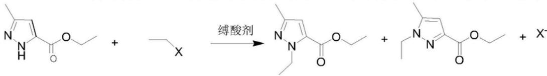
将吡唑酯在溶剂条件下,加入缚酸剂和催化剂,向体系中通入卤代乙烷气体,反应至合格,得到乙基物。
