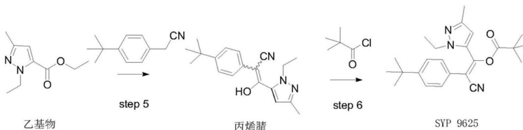
[0005] 根据相关专利CN1626520A,(实施例中C-D),此专利记载使用硫酸二甲酯作甲基化反应,吡唑酯与硫酸二甲酯在二氯甲烷体系中反应,40℃反应4小时合格,降温,经过水洗、碳酸氢钠洗、氯化钠洗,得到乙基物粗品。该反应得到产物收率55~60%。
