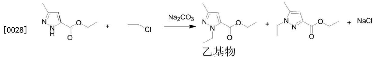
[0029] 取吡唑酯乙醇液268.9g(吡唑酯乙醇液中吡唑酯定量含量为13.39%),升温至98℃,减压蒸馏乙醇,至98℃/-98kPa,后停止蒸馏,稍降温,趁热向体系中滴加50g DMF和0.3克催化剂(TBAB(四丁基溴化铵)),降温至40℃,再投入50g碳酸钠固体,升温至70℃,开始插底通氯乙烷气体,通气流量为25g/h,通入5小时后,分析原料吡唑酯含量≤3.5%为合格。分析合格后,降温过滤,母液即为乙基物的DMF溶液;
