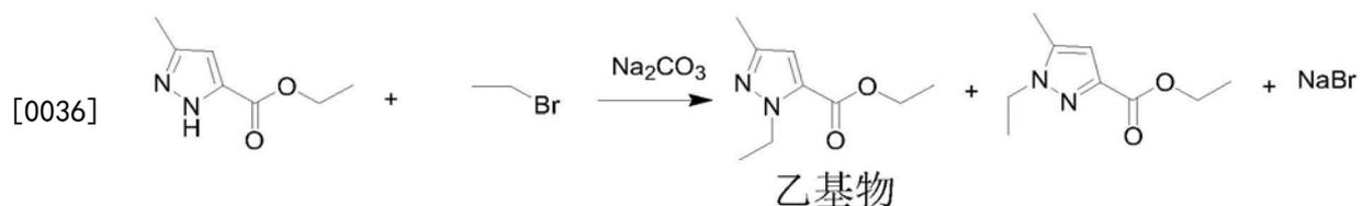
[0037] 工业生产一批次吡唑酯乙醇液,重量4100kg,定量含量15.75%,体系抽真空,至-98kPa,升温,减压脱溶至98℃/-98kPa,停止蒸馏,向体系中滴加1000kg,降至室温后,向釜中投入1000kg碳酸钠和10kg TBAB,反应釜升温至70℃,向釜中缓慢通入氯乙烷气体,通气
