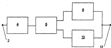
1. 一种估算信号的信号干扰比的方法，所述方法提供至少第一估算过程和第二估算过程，其中，为了对所述信号使用所述估算过程，根据所述信号的当前特性在所述估算过程中进行选择、以便选择最适合于所述信号的当前特性的估算过程；所述第一估算过程包括从宽带信号即去扩展之前的信号计算的宽带干扰估算，而所述第二估算过程包括从窄带信号即去扩展之后的信号计算的窄带干扰估算。
