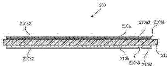
1. 一种电极位于压电陶瓷片同一面上的压电陶瓷驱动片,包括基片、压电陶瓷片,压电陶瓷片具有面向基片的一面和相对基片的另一面,且在所述两面上分别具有导电涂层,其特征在于,在所述与基片相对的另一面上的导电涂层仅涂覆所述另一面的一部分,所述面向基片的一面上的导电涂层涂覆所述面向基片的一面且延伸绕过所述压电陶瓷片的一端至所述与基片相对的另一面上,并与所述与基片相对的另一面上的导电涂层隔开一预定距离。
