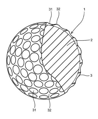
심 경도 (쇼어 C 경도), 구상 코어의 중심으로부터 표면을 향하여, 2.5 mm, 5 mm, 7.5 mm, 10 mm, 12.5 mm, 15 mm 지점의 경도 (쇼어 C 경도), 구상 코어의 표면 경도 (쇼어 C 경도) 를 각각  $H_0$ ,  $H_{2.5}$ ,  $H_5$ ,  $H_{7.5}$ ,  $H_{10}$ ,  $H_{12.5}$ ,  $H_{15}$
