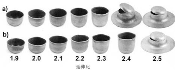
FIG. 40 a) 0.85 mm/s ; b) 2.5 mm/s で異なる延伸比による延伸後の合金14からのカップの写真。
