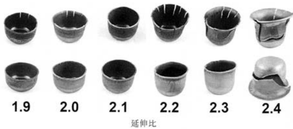
FIG. 39 a) 0.85 mm/s ; b) 2.5 mm/s で異なる延伸比による延伸後の合金6からのカップの写真。
