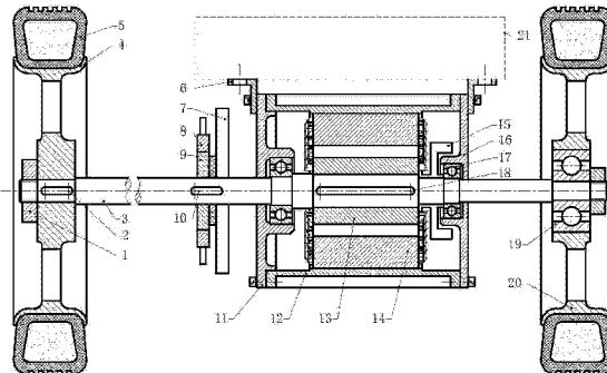
1. 一种直驱型电动三轮车的驱动装置,包括一个轴(3),其特征在于:电机、链轮(8)、超越离合器(9)和风扇(7)布置在轴(3)的中间,左轮毂(4)通过轮毂键(2)连接在轴(3)的左端,右轮毂(20)通过车轮轴承(19)连接在轴(3)的右端;两个轮胎(5)分别布置在左轮毂(4)、右轮毂(20)中;左轮毂(4)、右轮毂(20)通过轴端锁紧螺母(1)与轴(3)轴向固定,链轮(8)、超越离合器(9)与布置在车前面的驾驶员脚踏板相连;
