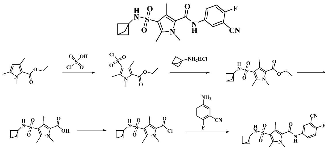
**步骤 A:** 根据实施例 5, 在步骤 A 中用 1,3,5-三甲基-1H-吡咯-2-甲酸乙酯替代 1,3-二甲基-1H-吡咯-2-甲酸乙酯, 制备 4-(氯磺酰基)-1,3,5-三甲基-1H-吡咯-2-甲酸乙酯。<sup>1</sup>H-NMR (500 MHz, CDCl<sub>3</sub>): δ 4.36 (q, J = 7.0 Hz, 2H), 3.85 (s, 3H), 2.60 (d, J = 3.0 Hz, 6H), 1.41 (t, J = 7.5 Hz, 3H). <sup>13</sup>C-NMR (125 MHz, CDCl<sub>3</sub>): δ 161.28, 139.79, 128.49, 123.94, 121.38, 60.78, 33.62, 14.31, 11.64, 11.53.
