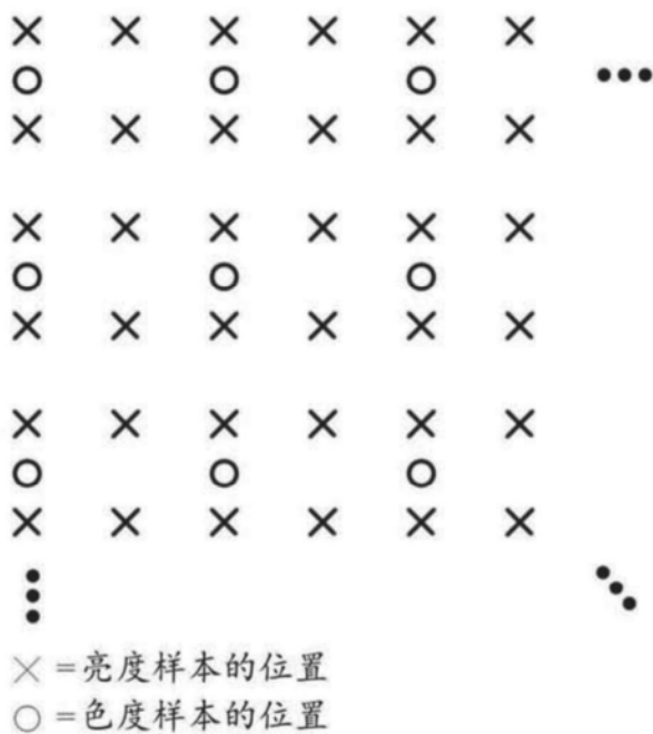
图片中4:2:0亮度和色度样本的标称垂直和水平位置
