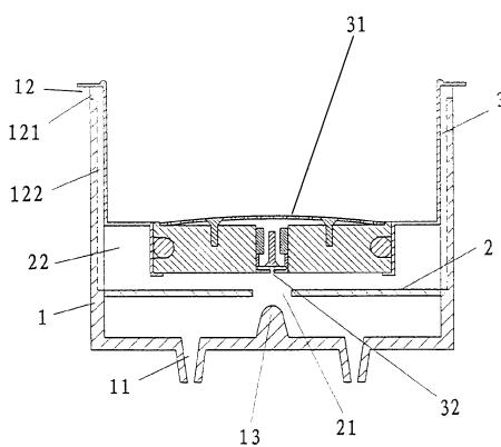
1、高压咖啡机泡沫产生及引流结构，咖啡容器内设置有隔板，且该容器底部设置有导出口，其特征在于：于上述容器周缘顶部设置一个或一个以上的进气槽，又于该容器底面凸设凸体；上述隔板对应于上述凸体的位置设置有通孔，并该通孔位置与咖啡盛篮导出口位置对应，且隔板置于凸体的上方，以使容器内设置咖啡盛篮时该咖啡盛篮底部与隔板间具有间隔层。
