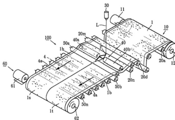
1. 一种卷料的分割方法,利用激光束将在长条的金属箔的至少一方的面涂覆有活性物质层的卷料沿长度方向切断,其特征在于:
