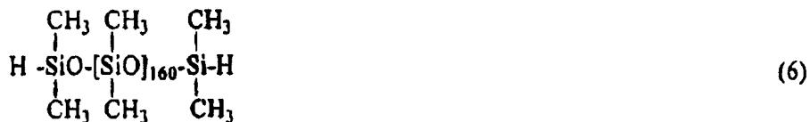
( $\text{H}/\text{Vi}$  为 0.95)；和 0.05 份包含 1% 铂原子的氯铂酸—乙烯基硅氧烷络合物的二甲基聚硅氧烷溶液均匀混合在一起，将制得的组合物加热到  $150^\circ\text{C}$  固化 30 分钟，得到针入度为 120 的固化产品。
