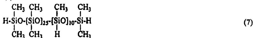
( $\text{H}/\text{Vi}$  为 0.5)；和 0.05 份包含 1% 铂原子的氯铂酸—乙烯基硅氧烷络合物的二甲基聚硅氧烷溶液均匀混合在一起，将制得的组合物加热到  $150^\circ\text{C}$  固化 30 分钟，从而得到针入度为 65 的固化产品。
