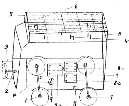
1、一种具有风能太阳能发电电动车，它的构造特征在于它包括：电动车主体（1），安装位于车正前方风力发电机组（2）及安全网罩（3），安装于车顶上方风力发电机组群（4）及风力发电机组群左右两侧风向导流板（5），最上层面安装太阳能光伏发电系统（6），车轮轮毂电机（7），车内高能蓄电池组（8）：有（8-1）为后轮常用蓄电池、（8-2）为前轮常用蓄电池、（8-3）为备用电池，安装方向盘上电池组切换控制充发电装置（9），监控仪表（10）及外电源充电接口（11）等结构组成。
