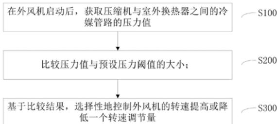
1. 一种空调外风机的转速控制方法,所述空调包括压缩机和室外换热器,所述室外换热器配置有所述外风机,其特征在于,所述转速控制方法包括:
