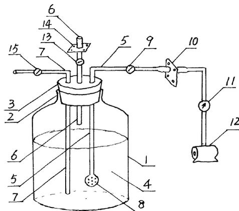
1、液体菌种培养器，容器（1）内装有培养基（4），容器口（2）通过塞子（3）密封，塞子（3）竖向有三个通孔，通孔内分别置有进气管（5）、排气管（6）和出液管（7），其特征在于：进气管（5）内端口通入培养基（4）内，进气管（5）在容器（1）外的部分，依次设有阀门（9）、过滤器（10）和气泵（12）；排气管（6）内端口高于培养基（4）液面，排气管（6）在容器（1）外的部分，依次设有阀门（13）和过滤器（14）；出液管（7）内端口插入容器（1）底部，出液管（7）在容器（1）外的部分，设有阀门（15）。
