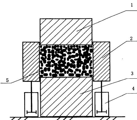
1. 一种随动式模压装置，包括上压头(1)和与其相适应的下压头(3)、所述上压头(1)、下压头(3)均为柱体，其特征在于：模框(2)套装在相对同轴设置的所述上压头(1)和下压头(3)的外侧，所述模框(2)的内壁为与上压头(1)相适应的柱体，并与上压头(1)和下压头(3)呈滑动配合，所述模框(2)上连接有脱模装置，所述脱模装置辅助于所述模框(2)，所述模框(2)的位置随时对称于上压头(1)和下压头(3)相对模框(2)的位移。
