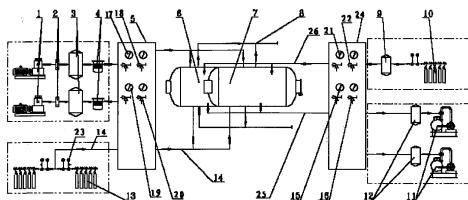
1、多功能舱，包括舱体部分，特征在于舱体部分设有连接的供排气系统、供排氧系统、负压系统、消防水系统、自动操舱系统、供配电系统，自动操舱系统控制连接供排氧系统及负压系统，供排气系统、消防水系统分别通过控制台控制连接至舱体部分。
