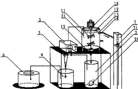
1. 一种含油污泥的处理设备,包括油泥清洗罐(1),盛泥罐(2),盛泥罐(4),旋射流分离器(3),控制器(5),离心机(6),清水槽(7),其特征在于:所述清洗罐(1)上方设环状溢流堰(12),与清洗罐(1)壁之间形成凹槽式隔油槽(13),通过排水阀(14)与清水槽(7)相通,清洗罐(1)内设搅拌器(11)和温度传感器(51),温度传感器(51)与控制器(5)电连接;清洗罐(1)下方安设盛泥罐(2),盛泥罐(2)与旋射流分离器(3)管路相连,旋射流分离器(3)下方设盛泥罐(4),与离心机(6)管路相通;所述盛泥罐(2)、清水槽(7)中分别安装泥浆泵(21)、清水泵(71)。
