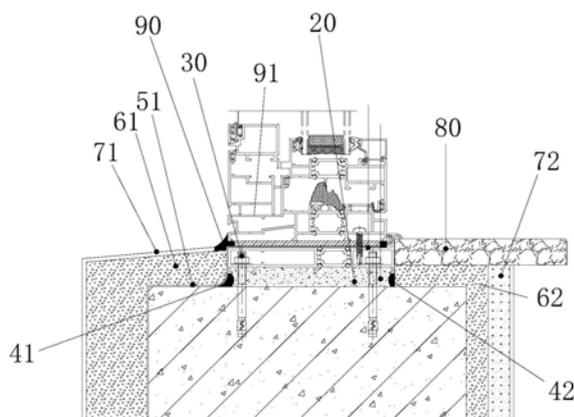
1. 一种门窗附框的安装结构,其特征在于,包括固定于墙洞处的附框部件,所述附框部件的外周侧与墙洞之间设置有防水填充物,且所述附框部件采用穿设于附框部件、防水填充物并固定于墙洞内周的锁紧件固定于墙洞;所述附框部件的外周侧靠近于室外侧处设置有第一密封胶,所述附框部件的外周侧靠近于室内侧处设置有第二密封胶;所述第一密封胶、所述第二密封胶均分别与墙洞相接;所述附框部件的室外侧、所述第一密封胶、墙洞对应于附框部件的室外侧覆设有室外防水层,所述室外防水层覆设有室外保温层;所述附框部件的室内侧、所述第二密封胶、墙洞对应于附框部件的室内侧覆设有室内保温层。
